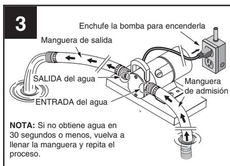
**LA MANGUERA DE ADMISIÓN VA DENTRO DEL AGUA; LA MANGUERA DE SALIDA PERMANECE FUERA DEL AGUA. EL MOTOR DEBE ESTAR SECO**
