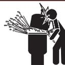
Los sistemas de circulación operan a alta presión. Cuando se repara alguna parte del sistema de circulación (por ej., aro de bloqueo, bomba, filtro, válvulas, etc.), puede ingresar aire al sistema y presurizarse. El aire presurizado puede hacer que la cubierta de la carcasa, la tapa del
