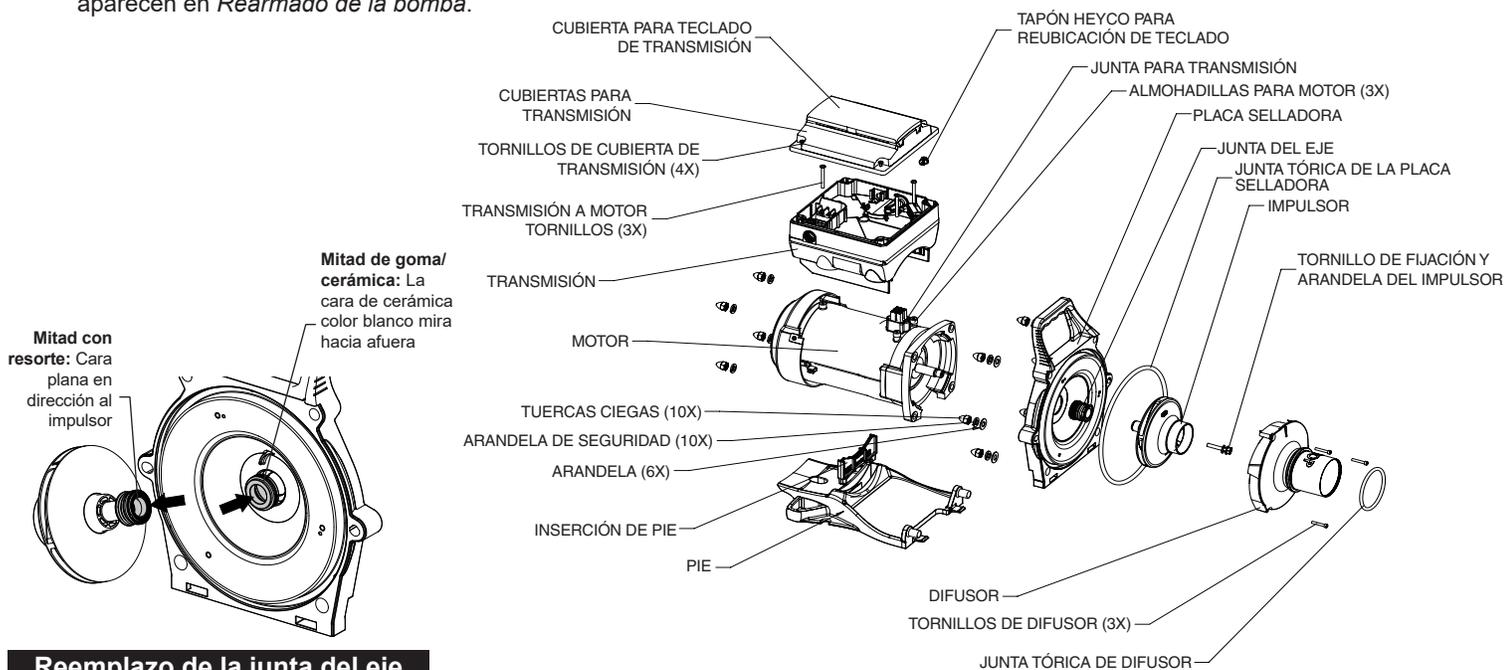
Reemplazo de la junta del eje
