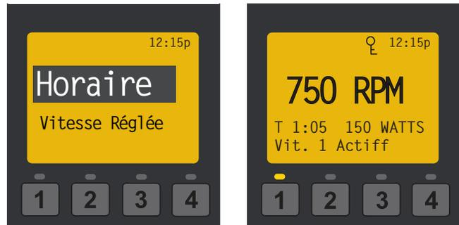
**Remarque :** La pompe ne fonctionnera aux vitesses programmées selon l'horaire qu'une fois le bouton **Start/Stop** (voyant DEL allumé) enfoncé de façon à régler la pompe en mode horaire.
