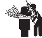
**PRESSIION DANGEREUSE : RESTER À L'ÉCART DE LA POMPE ET DU FILTRE PENDANT LE DÉMARRAGE**
